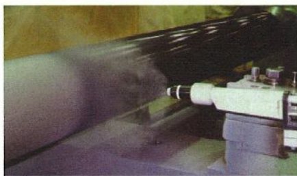
Sprühvorrichtung zur MPC-Beschichtung.
