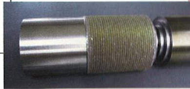
PTA-Beispiel einer Laser- auftrags-Schweißung.
