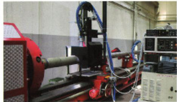
PTA-Beschichtungsanlage bei Hunger.
