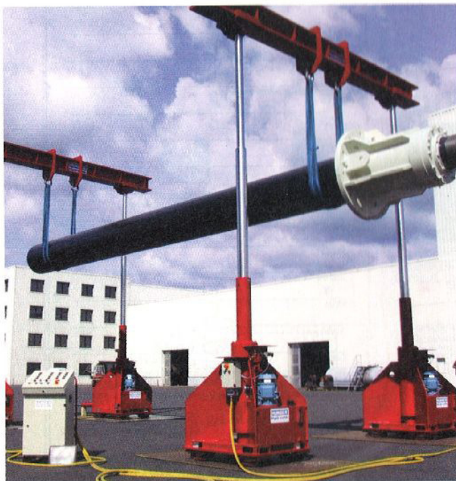
'Hydlift 100' im Einsatz: Je nach Arbeitsaufgabe mit zwei oder vier Liftsystemen. Vor der Inbetriebnahme gilt es lediglich, die Lastaufnahme-Traversen in den schwenkbaren Kopfstücken an den Teleskopzylindern zu sichern.
