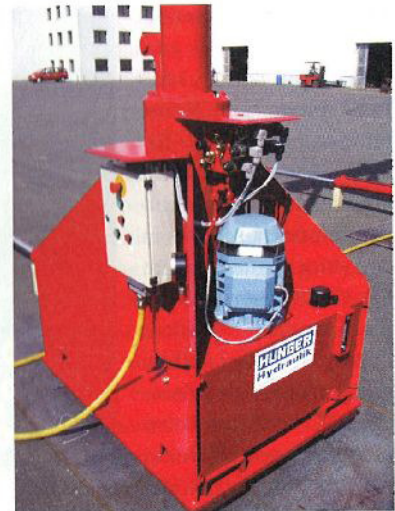
Einzelhubeinheit: integriertes Hydraulik-Aggregat mit Einrichtpult und ausgelegtem Fahrzylinder.
