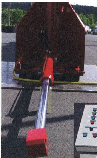
Hydraulikzylinder des Fahrtriebes: lastunabhängige Geschwindigkeitseinstellung über Stromregelventile.
