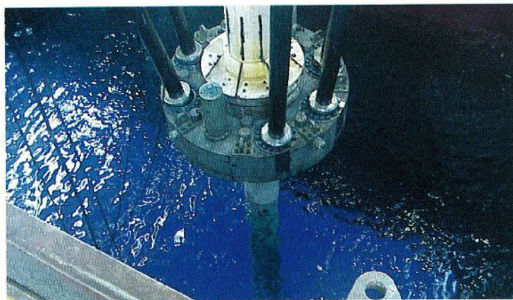
Neben sechs beweglichen Schiffsschrauben, die über GPS die exakte Position des Schiffes halten, sorgen sechs riesige Hydraulikzylinder für die absolute ‚Ruhelage‘ des Bohrkopfs.
