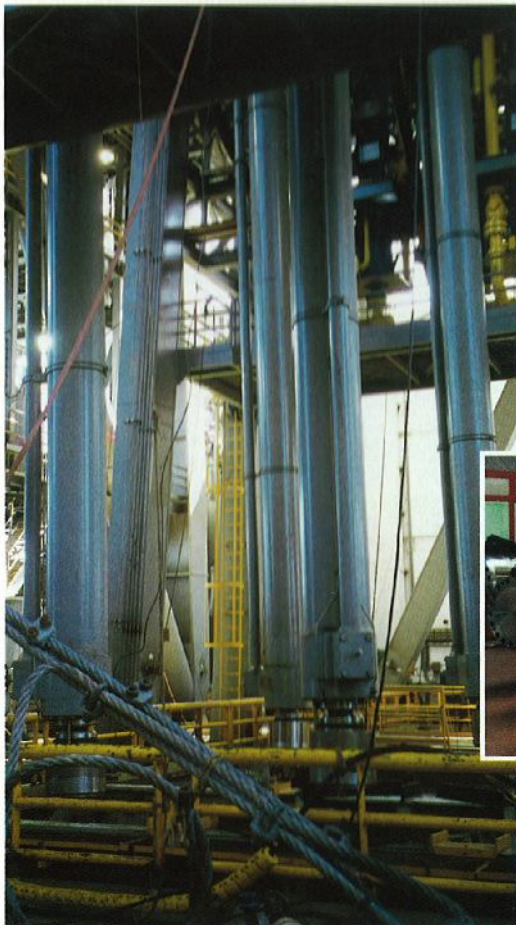
Die Kolbenstangen wurden mit der Metalloxid-Beschichtung Hunger-Ceraplate 2000 versehen, die sich bereits in vielen extremen Einsatzfällen bestens bewährt hat, beschichtet. Dabei handelt es sich um einen zweilagigen Schichtaufbau.
