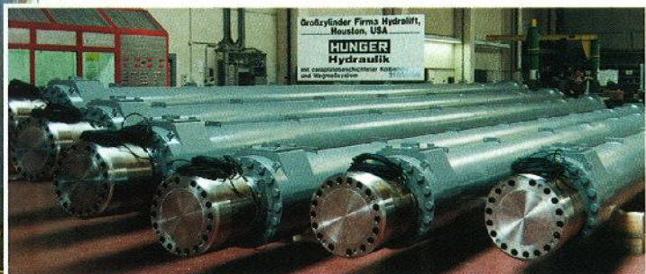
Die Metalloxid-Beschichtung der Stangen wurde durch Diamanthonen und Polieren feinstbearbeitet. Die daraus entstehende, sehr glatte Oberfläche verlängert die Lebensdauer der Dichtungen erheblich. Zudem können sich kaum noch Verschmutzungen anlagern.
